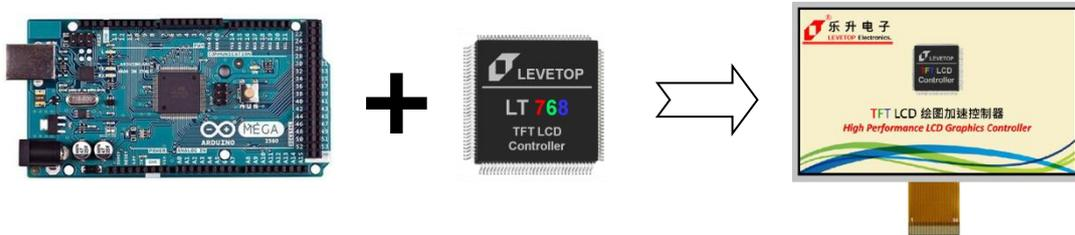
Arduino Mega2560 是一款基于 ATmega2560(datasheet)的微控制器板。它有 54 个数字输入/输出引脚（其中 15 个可用作 PWM 输出）、16 个模拟输入、4 个 UART（硬件串行端口）、1 个 16 MHz 晶体震荡器、1 个 USB 连接、1 个电源插座、1 个 ICSP 头和 1 个重置按钮。它包含了支持微控制器所需的一切；只需通过 USB 线将其连至计算机或者通过 AC-DC 适配器或电池为其供电即可开始。以下将举例说明 Mega2560 连接到 LT7683 的方式，及将 LT768 库整合到 Arduino IDE 上，而关于 LT768 的硬件与函数库信息，请参考 LT768x 规格书与应用手册。
